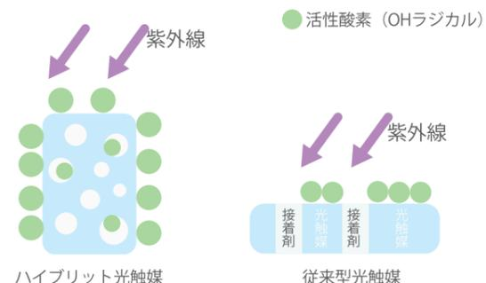
吸着性能を有して光触媒の弱点とされる即効性を兼ね備えました。再生機能により回復するため交換の必要がなく、環境にやさしい製品です。
