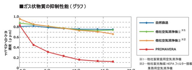
30 m<sup>3</sup>試験空間でガス成分であるホルムアルデヒドを充滿させ、数値が安定したところで試験する空気清浄機の電源を入れ、そこから減衰量を測定したグラフです。
